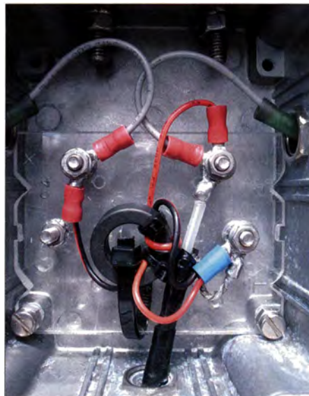
Bild 6: Übertrager aus Doppellitze auf einem Ferritringkern FT82-77 im geöffneten Schutzgehäuse
