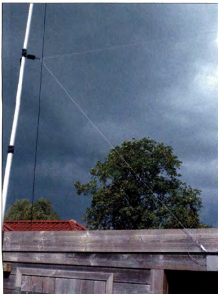
Bild 1: Teilansicht der zwischen Glasfaser-Teleskopmast und Hausgiebel abgespannten Empfangsschleifenantenne
