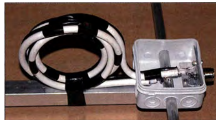
Bild 4: Aircell5 (50 Ω) und TV-Kabel (75 Ω) parallel an einer 18-Ω-Yagi für 6 m
