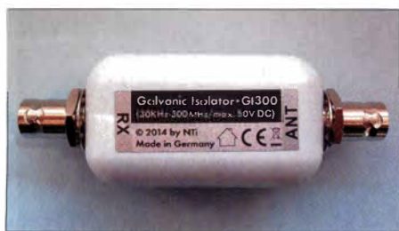
Bild 8: Kommerzieller Trennübertrager zur Unterdrückung von Störungen, die über Masseverbindungen bzw. den Mantel des Koaxialkabels zum Empfänger gelangen können. Fotos: DF2BC (4), DL1ABJ (1), Red. FA (1)
