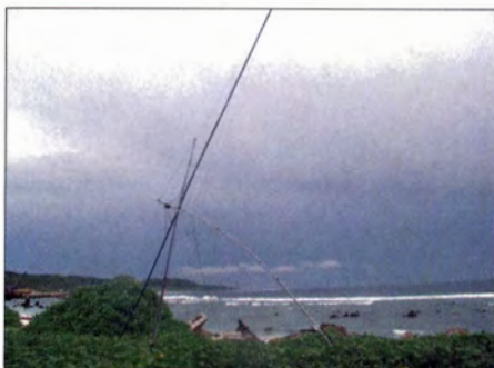
Unwetterschaden: umgefallener Spiderbeam
