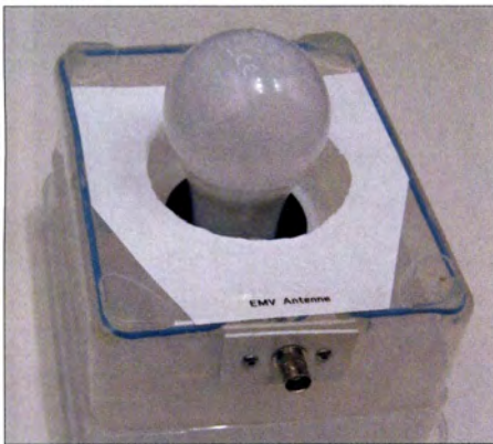
Bild 1: Messadapter zur Überprüfung der HF-Störstrahlung von LED-Lampen
