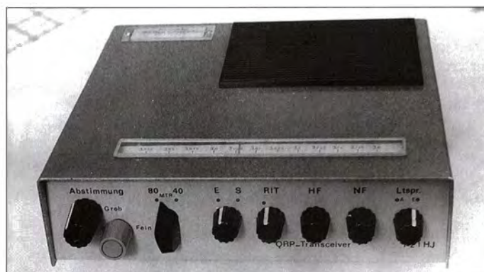
Bild 3: Originalfoto des Geräts von Y21HJ aus [1]; im Hinblick auf die geringe Bauhöhe befindet sich die Frequenzkala an der Oberseite des Geräts. Bedienelemente v. l. n. r.: Abstimmung grob/fein, Bandschalter, S/E-Umschaltung, RIT, RX-HF, RX-NF, Lautsprecherschalter; links hinten der „Abnahme“-Aufkleber der Deutschen Post. Foto: Y57WJ
