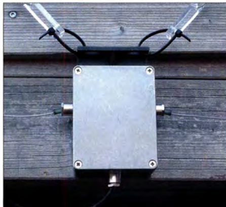
Bild 2: Im wetterfesten Schutzgehäuse am Fußpunkt der Schleifenantenne befindet sich der Übertrager zur Impedanzanpassung an das Koaxialkabel.
