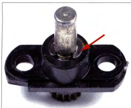
Bild 2: Die Lagerbuchse lässt sich relativ einfach abschrauben; die Achse ist mit einer Sicherungsscheibe versehen.
