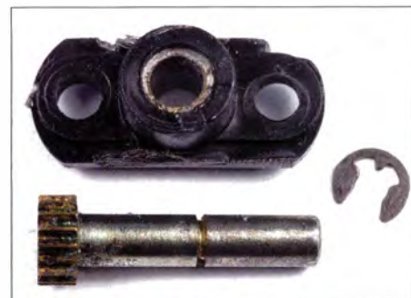
Bild 3: Nachdem die Sicherungsscheibe entfernt wurde, kann man die Achse aus dem Lager ziehen, reinigen und neu fetten.
