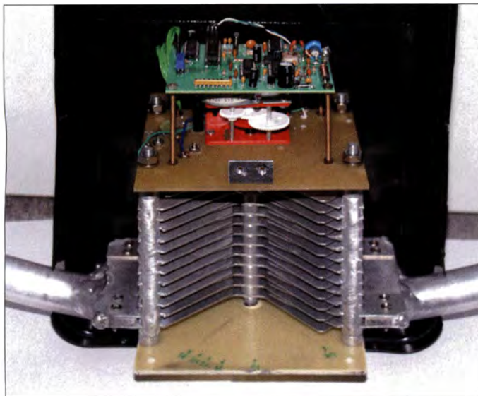
Bild 1: Geöffnete Abstimmbox der Magnetschleifen- antenne; oben die Platine mit der Steuerelektronik, darunter das Schrittmotor- getriebe und der Abstimm- drehkondensator
